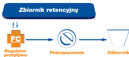
Rys. 17. Ograniczenie przepływu za systemem retencyjnym, włączonym do sieci kanalizacji deszczowej
