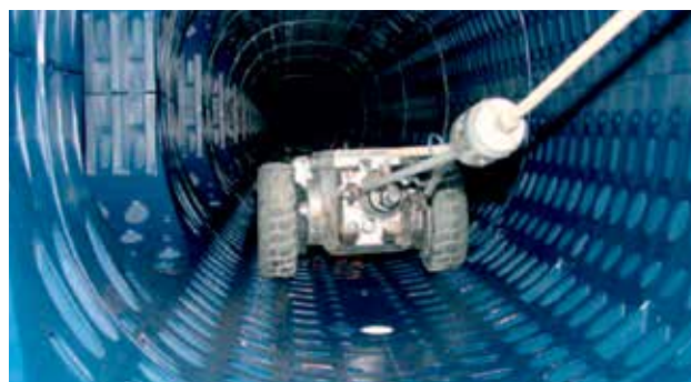
Rys. 12. Inspekcja w module złożonym ze skrzynek Wavin Q-Bic
