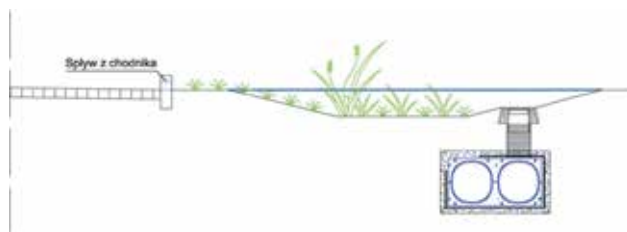
Rys 5. Zbiornik retencyjno-rozsączający z możliwością inspekcji i czyszczenia, umieszczony pod niecką z nasadzoną roślinnością. Przelew awaryjny z niecki infiltrowującej
