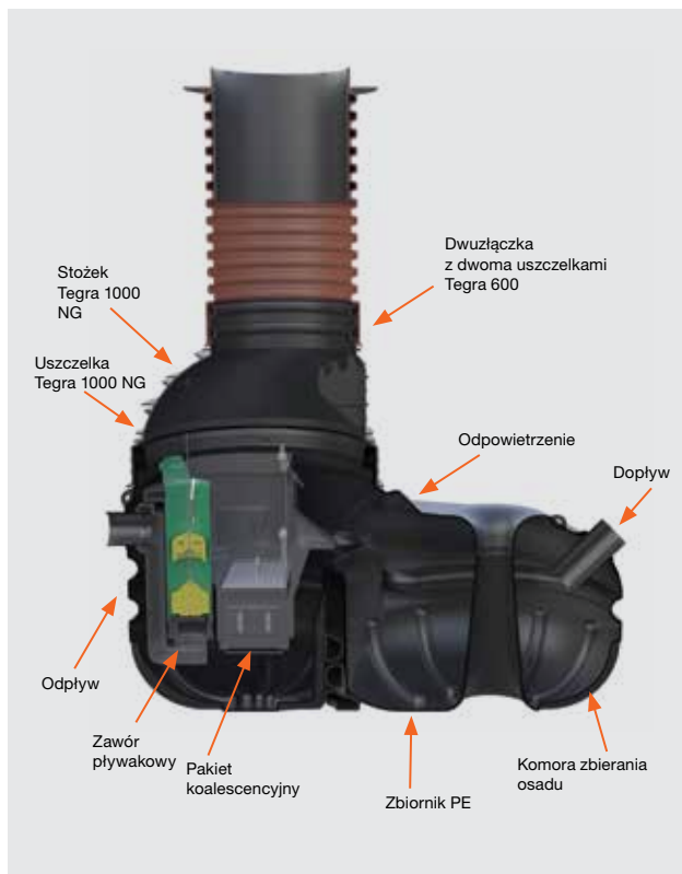
Rys. 39. Budowa separatora Wavin Certaro NS
