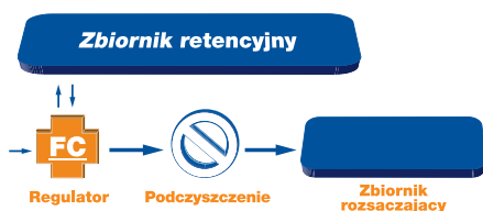
Rys. 18. Ograniczenie przepływu przez system podczyszczania i wypływu do zbiornika rozsączającego
