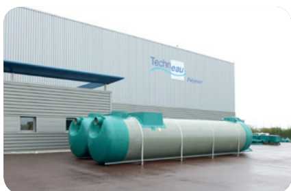
Dekantery zawieszin z poliestru. Przepływ 80 l/s przy obciążeniu 2m/h. Gmina Poitiers we Francji.
