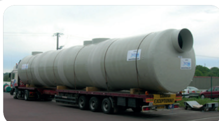
Poliestrowy Separator o przepływie 300 l/s, wyprodukowany „pod zamówienie” i zainstalowany przy autostradzie na Słowacji.
