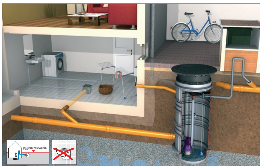
Rys. przedstawia urządzenie Duo, z pętlą przeciwwzalewową ułożoną w miejscu nieprzemarzającym
