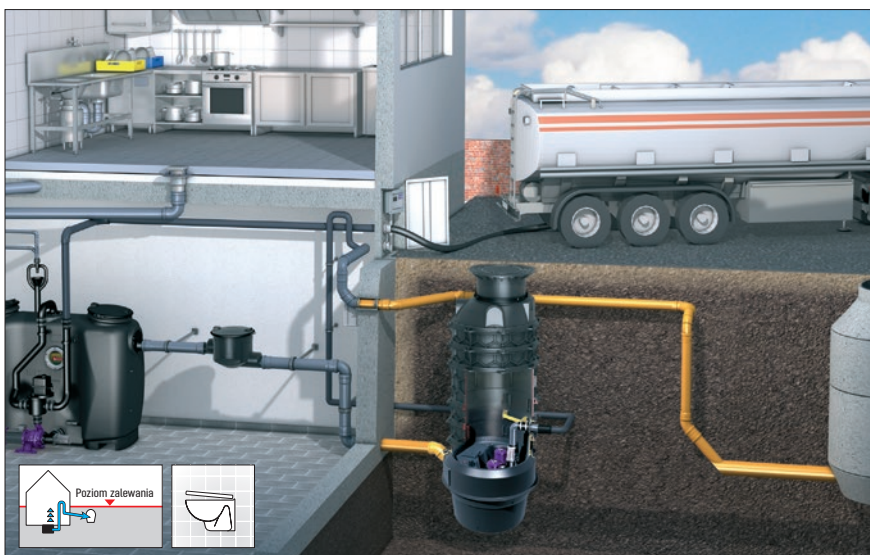
Rys. przedstawia przepompownię Aqualift F XL , podłączoną za separatorem tłuszczu
