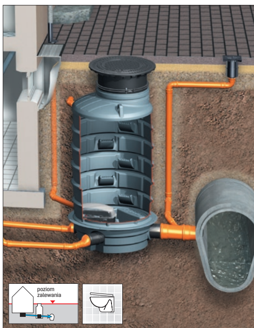
Z otworem rewizyjnym do późniejszego zainstalowania agregatu przeciwwzalewowego KESSEL p. str. 81
