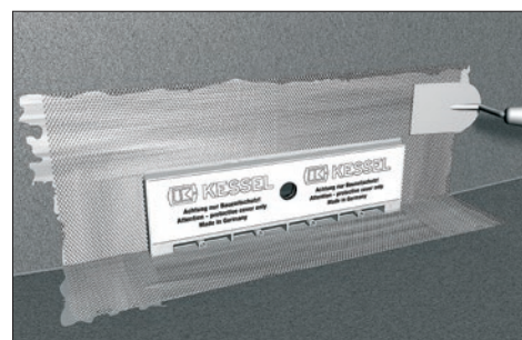
Wykończenie zabudowy uszczelnieniem alternatywnym.
