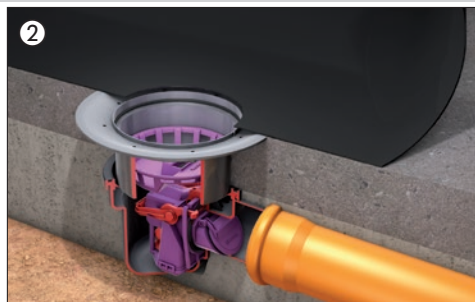
2 Założenie uszczelniającej taśmy elastomerowej.
