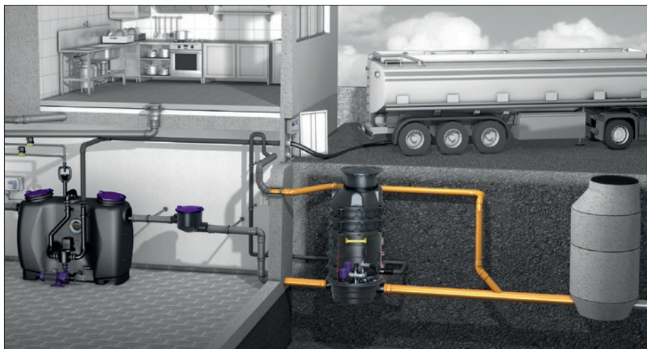
Ecolift XL do zabudowy na zewnątrz budynku
