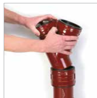
Połącz następną kształtkę lub rurę upewniając się, że znacznik centralny styka się równomiernie z krawędzią bosego końca.
