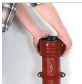
Połącz elementy upewniając się, że znacznik centralny styka się równomiernie z krawędzią bosego końca.
