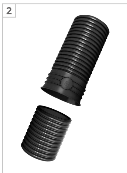
2. Połączenie rur następuje za pomocą kielichów wykonanych na rurach lub za pomocą kształtek. Do uszczelnienia połączeń niezbędne jest zastosowanie uszczelki elastomerowej.
