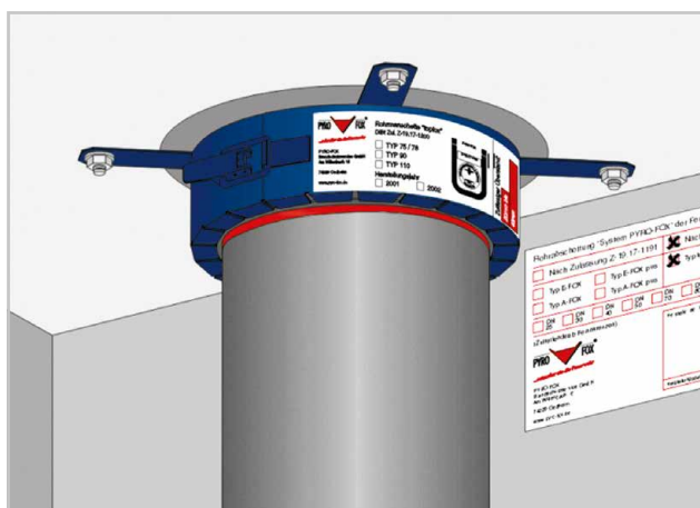
Rys. 42 a) Przejście przez strop
