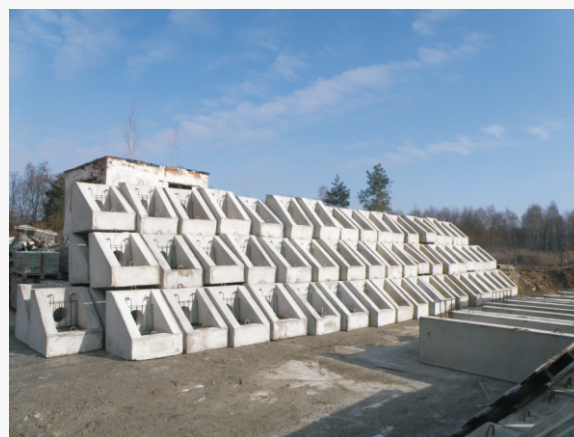
WYLOT TYP A z otworem \varnothing 160-350
