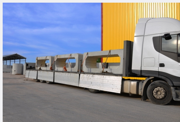
Przepusty skrzynkowe - przykładowy typ 300x80
