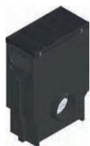
studzienka z ocynkowanym osadnikiem, z rusztem żeliwnym, prętowym, pręty wzdłużne, z powłoką KTL, kl. C 250
