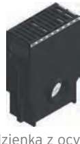
studzienka z ocynkowanym osadnikiem, z rusztem żeliwnym, szczelinowym SW 2x 85/20, czarnym, kl. C 250, z mocowaniem
