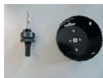
wiercenie otworu Ø 102 mm
