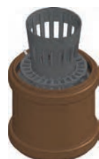
syfon pionowy DN 100 z osadnikiem
